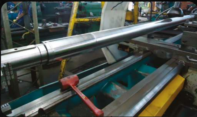
Eje 6 Mts. AISI 420 Ni Mo Bomba de condensado Multietapa
