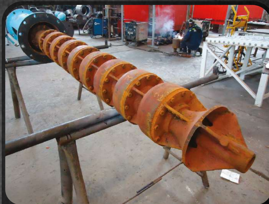
Bomba Circulación vertical centrifuga de una etapa, 880 rpm, 12450 GPM Worthington Corporation, 20 KMD 24. Central Termoeléctrica
