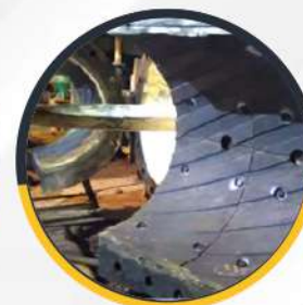
INGENIERÍA PARA LA RECONVERSIÓN DE BLINDAJES EN LÁMINA A PLACAS EN FUNDICIÓN ALTO CROMO, QUE PERMITE AUMENTAR LA VIDA ÚTIL DE LA EXTRUSORA.
