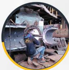
INGENIERÍA PARA LA RECONVERSIÓN DE BLINDAJES EN LÁMINA A PLACAS EN FUNDICIÓN ALTO CROMO, QUE PERMITE AUMENTAR LA VIDA ÚTIL DE LA EXTRUSORA.
