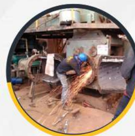
INGENIERÍA PARA LA RECONVERSIÓN DE BLINDAJES EN LÁMINA A PLACAS EN FUNDICIÓN ALTO CROMO, QUE PERMITE AUMENTAR LA VIDA ÚTIL DE LA EXTRUSORA.
