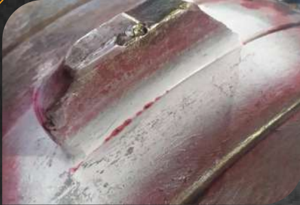
DIAGNOSTICO PRUEBA DE TINTAS PENETRANTES
